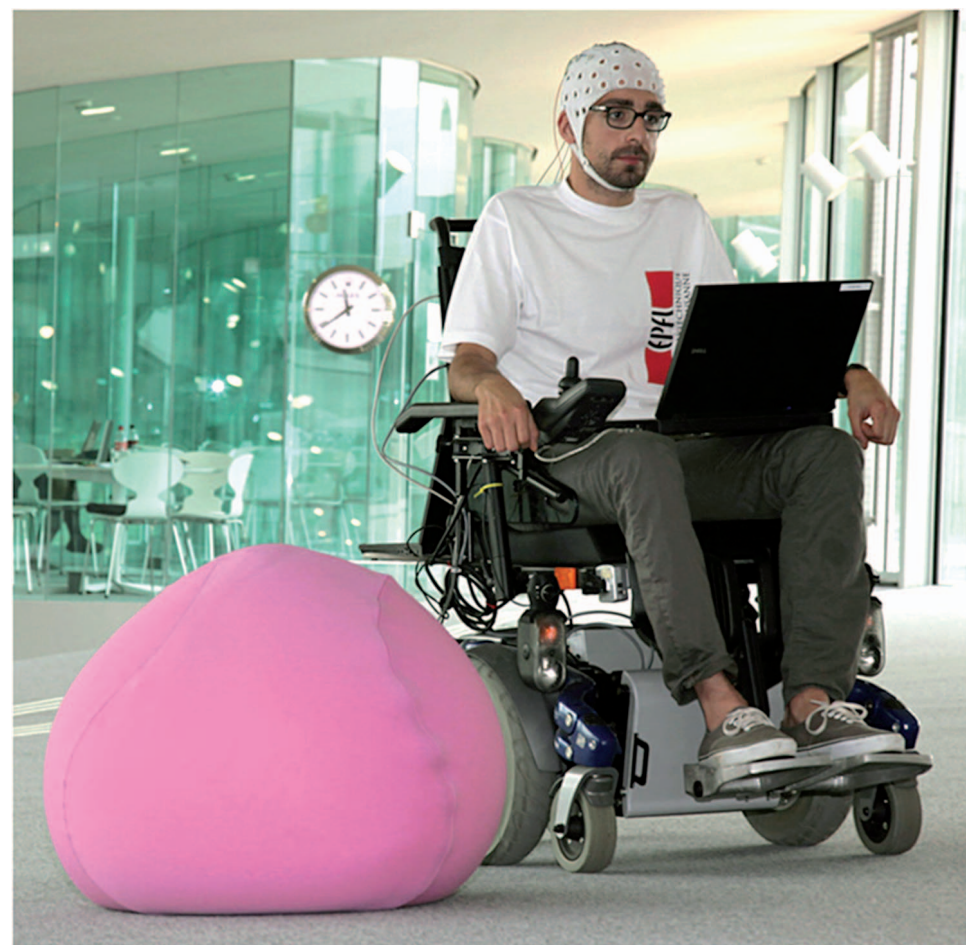
Figura 2. Cadeira de rodas controlada pelo cérebro. Os usuários podem dirigir essas cadeiras de rodas de forma confiável e segura por longos períodos de tempo, graças à incorporação de técnicas de controle compartilhado (ou percepção de contexto). Esta cadeira de rodas ilustra o futuro das neuropróteses inteligentes que, assim como nossa medula espinal e nosso sistema musculoesquelético, funcionam em conjunto com comandos motores decodificados a partir do córtex cerebral do usuário. Isso livra os usuários da necessidade de fornecer continuamente todos os parâmetros de controle de baixo nível necessários e, portanto, reduz sua carga de trabalho cognitiva
